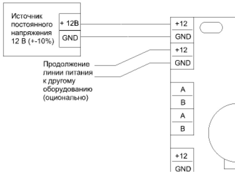
**ПРИМЕЧАНИЕ:** Контроллер имеет две совмещенные колодки для подключения питания. Это удобно при выполнении монтажа в тех случаях, когда контроллер находится «посередине» линии питания - например, в первую расключают пришедшую линию с питанием, а во вторую ее «продолжение» к остальному оборудованию.
