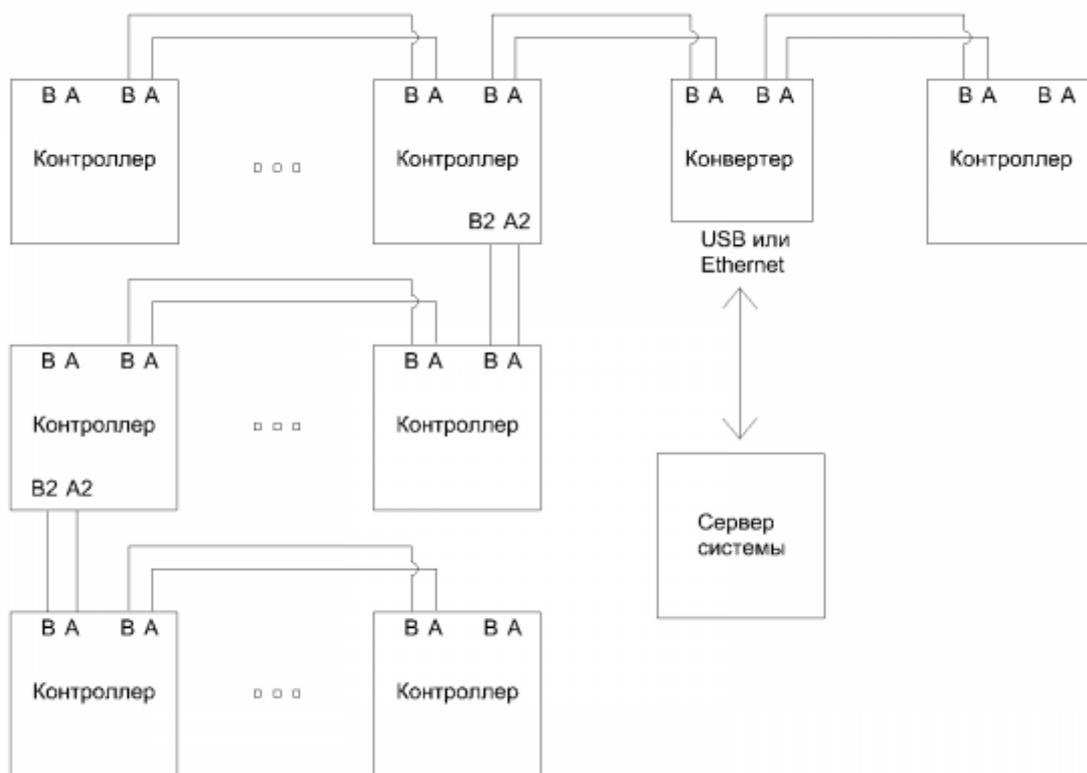
**ПРИМЕЧАНИЕ:** На схеме устройства, обозначенные как «контроллер» могут быть как контроллерами СКУД, так и устройствами сопряжения для охранной сигнализации.
