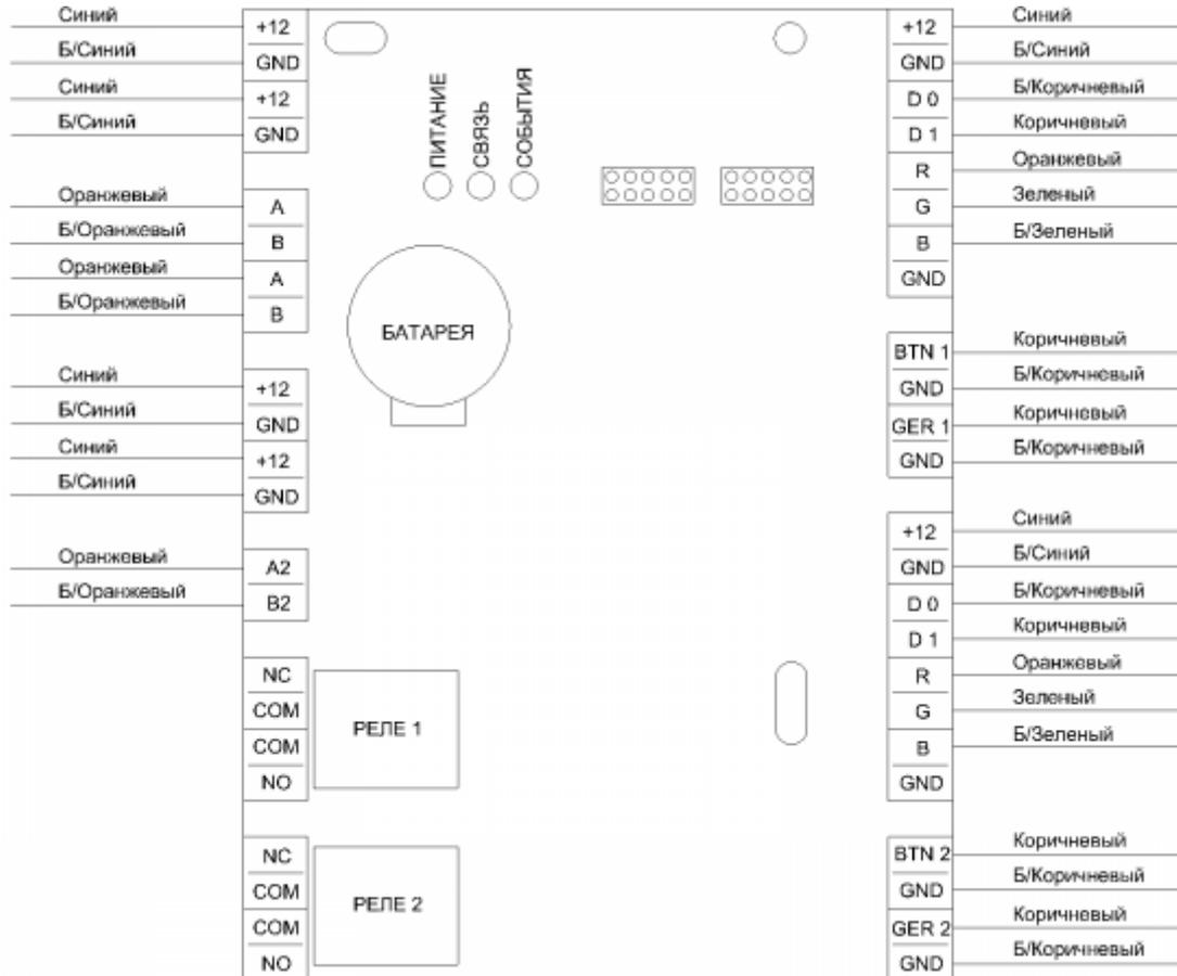
На схеме указаны рекомендованные цвета жил при использовании 4-х парного кабеля типа «витая пара» для расключения контроллера.
