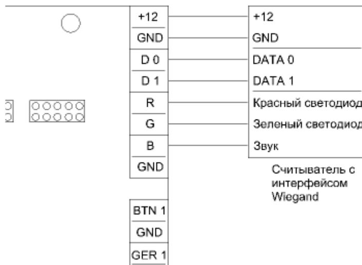
Для работы с контроллером используются считыватели (или иное оборудование, например, PIN клавиатура), работающие по протоколу Wiegand.
