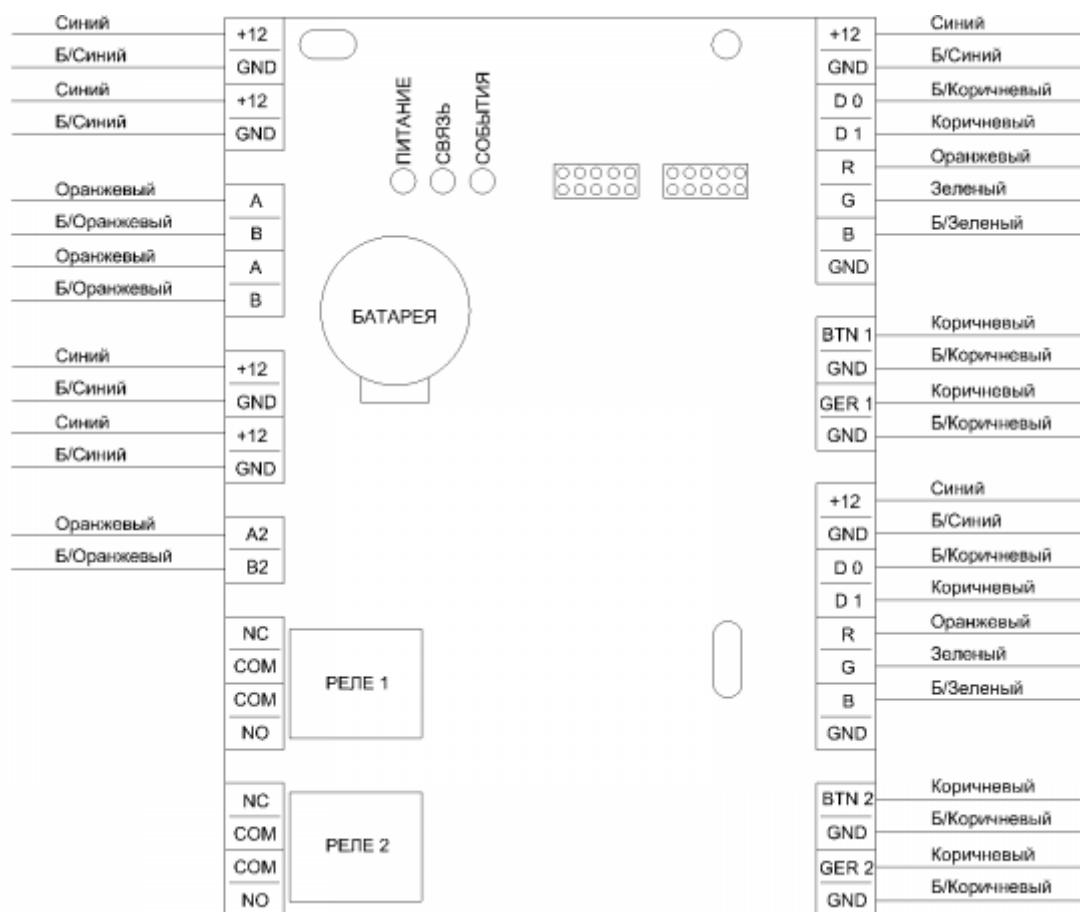
На схеме указаны рекомендованные цвета жил при использовании 4-х парного кабеля типа «витая пара» для расключения контроллера.
