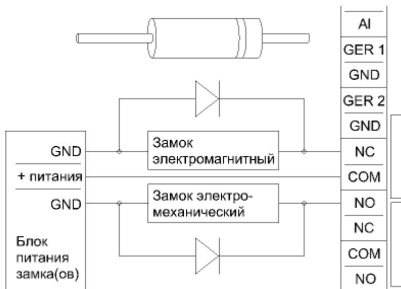
Схема подключения различных типов замков показана на рисунке.
