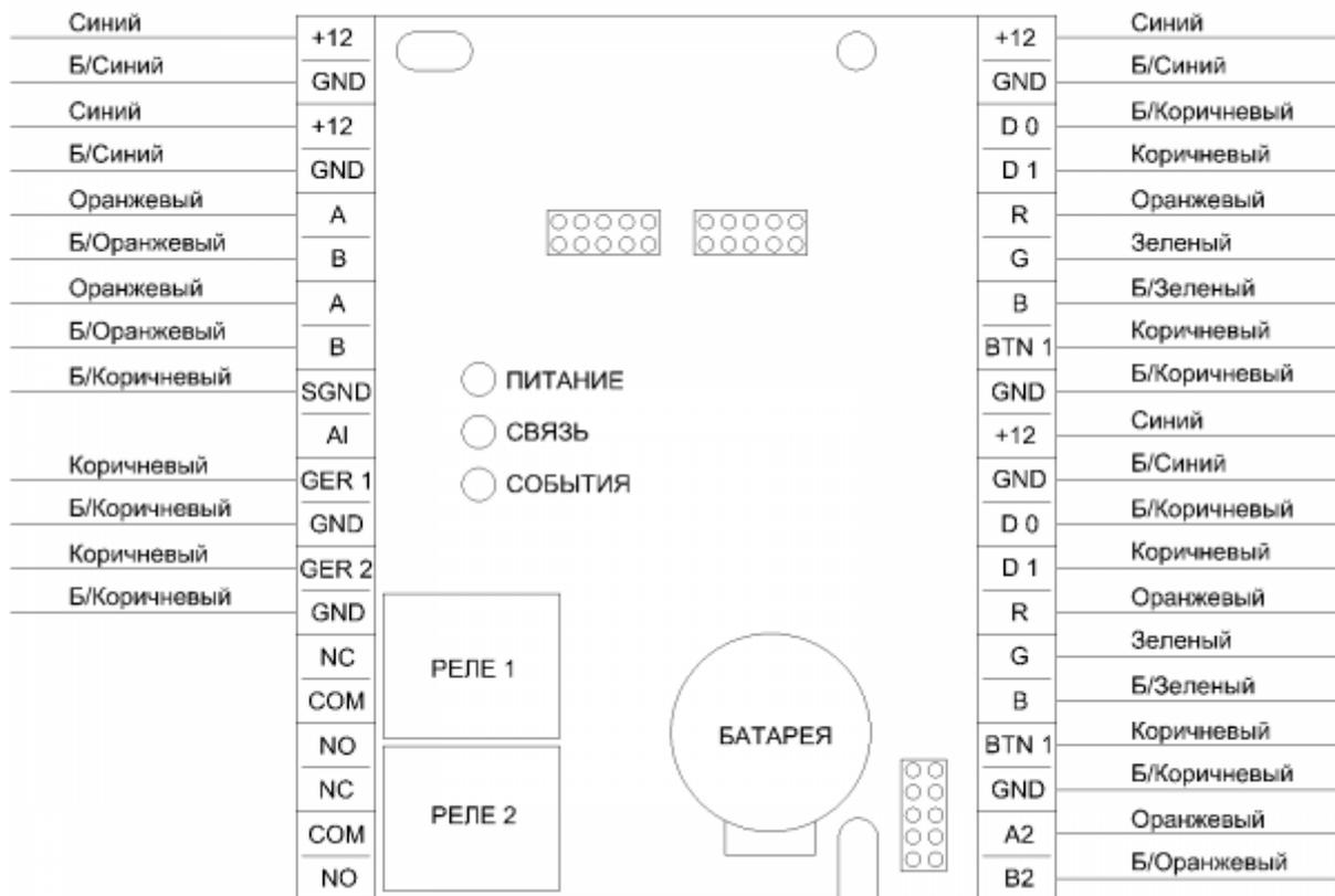
На схеме указаны рекомендованные цвета жил при использовании 4-х парного кабеля типа «витая пара» для расключения контроллера.
