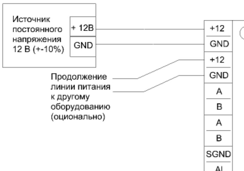
**ПРИМЕЧАНИЕ:** Контроллер имеет две совмещенные колодки для подключения питания. Это удобно при выполнении монтажа в тех случаях, когда контроллер находится «посередине» линии питания - например, в первую раскочуют пришедшую линию с питанием, а во вторую ее «продолжение» к остальному оборудованию.
