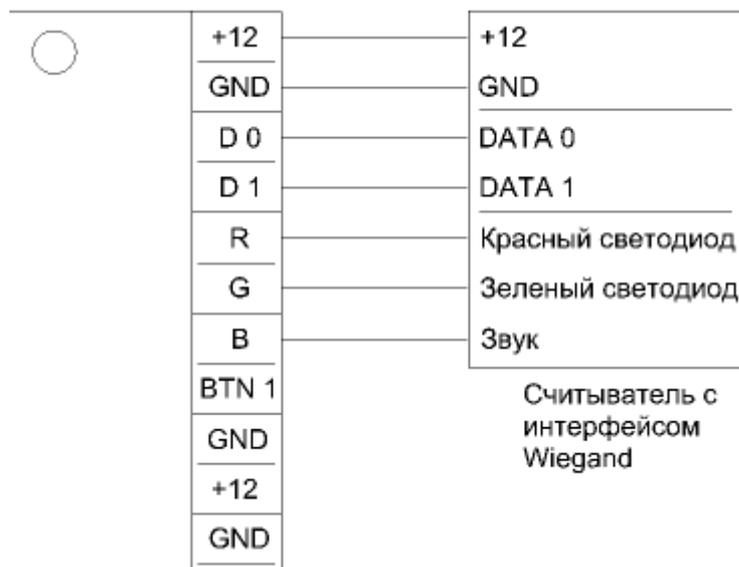
Для работы с контроллером используются считыватели (или иное оборудование, например, PIN клавиатура), работающие по протоколу Wiegand.
