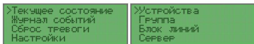
1 - Устройства. Из списка выбрать нужное устройство или извещатель и нажать «#». На экране отобразится адрес устройства, состояние (взят или не взят под охрану) и наличие связи с устройством.
