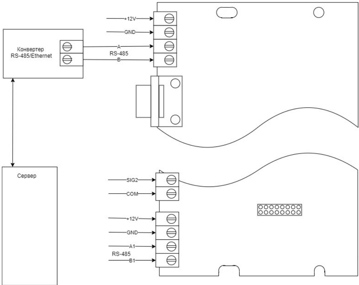
Подключение пульта к серверу возможно через конвертер по линии RS-485 (A,B).
